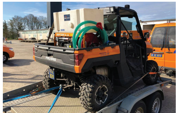
Små slukningsaggregater monteret på ATV eller 4x4 til support af hold med håndværktøjer.
