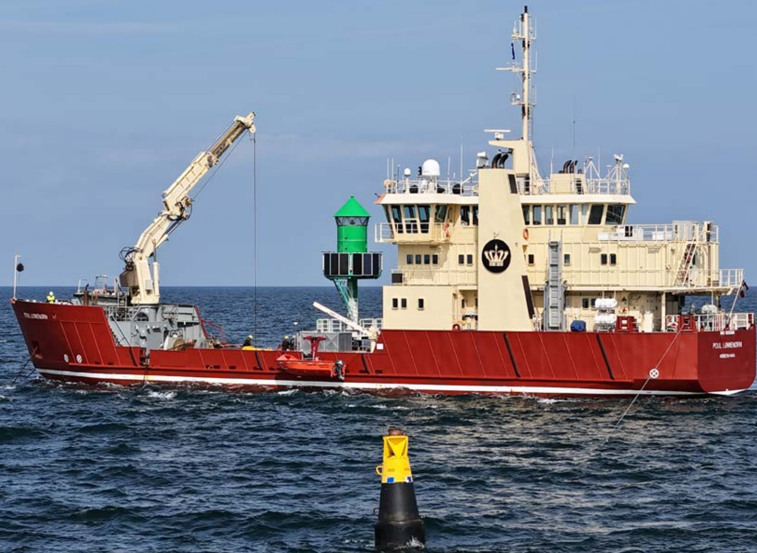
Inspektionsfartøjet POUL LØWENØRN i gang med håndtering af Storebæltsfyrr (Fyr i søen) samt sydkardinal, der mangler topbetegnelse i Rute T
