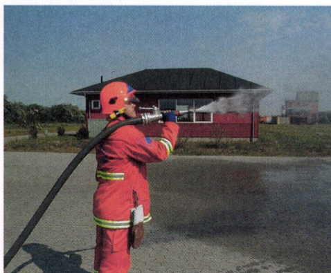
Tågestrålerør, hvor strålebilledet indstilles ud fra opgavens art
