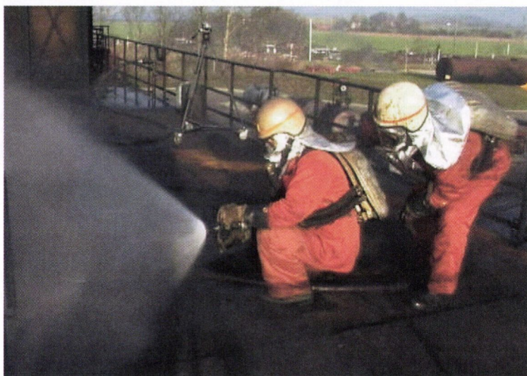
Tågestrålerør, hvor strålebilledet indstilles ud fra opgavens art
