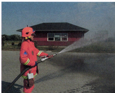
Tågestrålerør, hvor strålebilledet indstilles ud fra opgavens art
