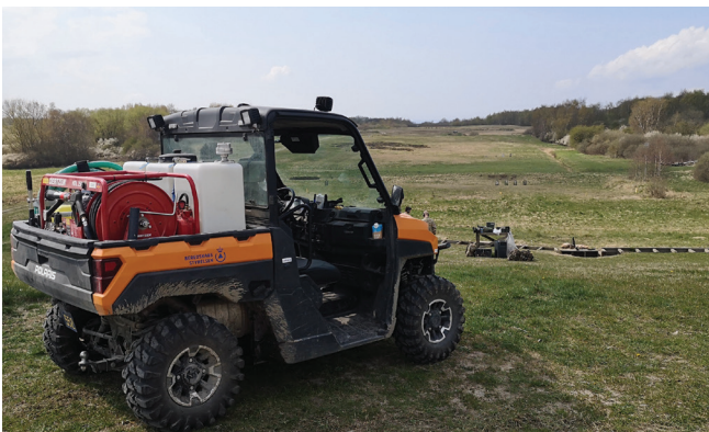
Små slukningsaggregater monteret på ATV eller 4x4 til support af hold med håndværktøjer.
