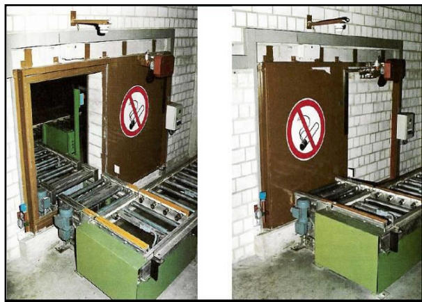
Figur 2.5: Billede af en port til lukning i en transportåbning.
