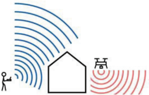
Figurtekst: Signalet fra dronepilot til drone kan blive svækket eller forhindret af objekter mellem dem, eller hvis afstanden bliver for stor.
