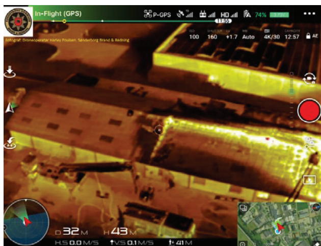
Figurtekst: Der er en synlig temperaturforskel i taget under kip og langs den tværgående brandsektionsvæg og brandkam. Temperaturforskellen illustreres ved at de lyse farver er varme og de mørke farver er kulde. Bygningen her har en næsten hvid signatur langs ryggen og ved brandkammen der viser en betydelige varmeforskel fra resten af omgivelserne.
