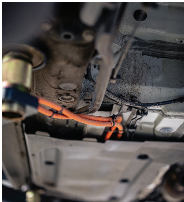
De to fotos viser batteripakken, som er taget ud og kabler i bunden af karrosseriet Foto: Beredskabsstyrelsen
