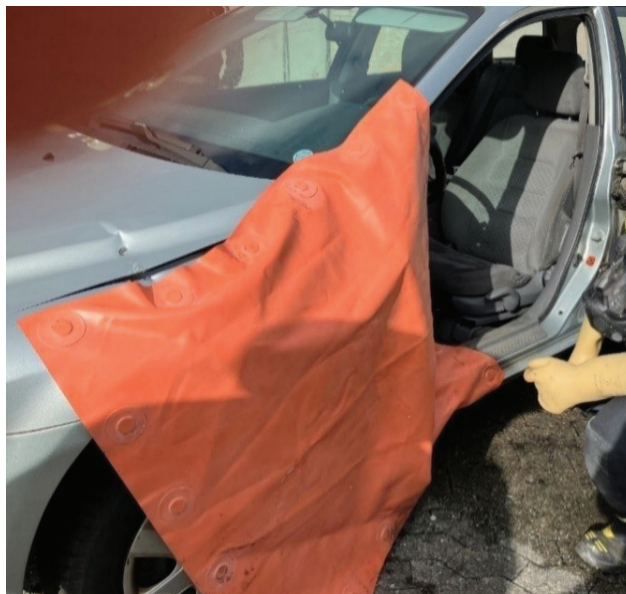
Afdækning af blotlagte kabler og del af karrosseri som ekstra sikkerhedsbarriere
