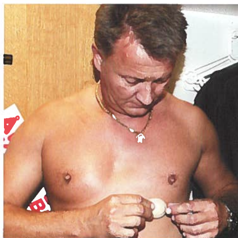
Plaster med indbygget sensor og afsender
