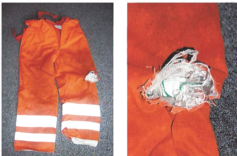
Skærebukser, som viser de særlige tråde, der standser motorkædesaven
