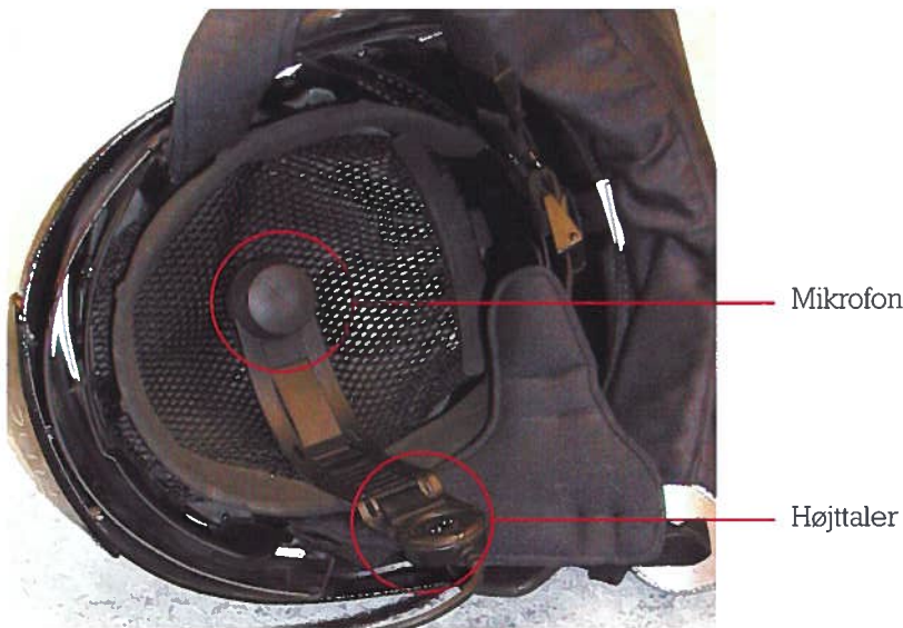
Mikrofon og højttaler monteret i en indsatshjelme
